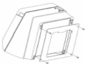
用4 ST3螺丝钉将托架固定在打印机上
