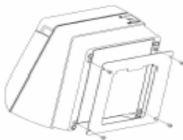
用4 ST3螺丝钉将托架固定在打印机上
